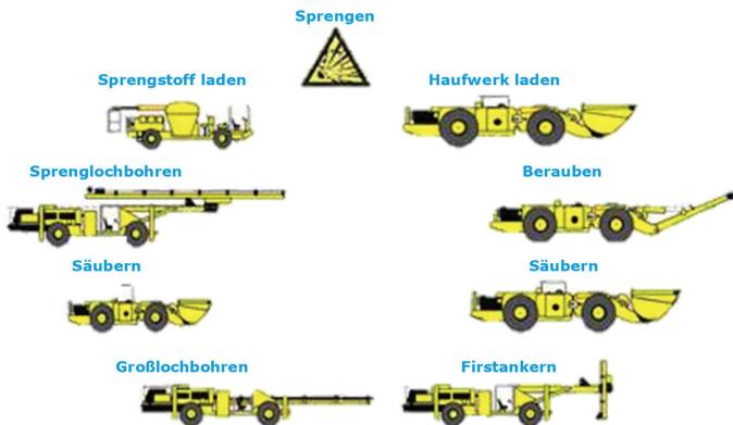
Abbildung 1: Gewinnungszyklus Bohren und Sprengen (Quelle: K+S AG).
