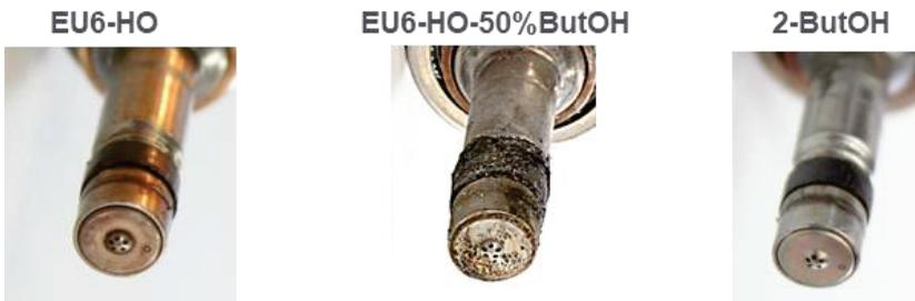
*Abbildung 4: Bild der Einspritzdüse nach 500 h Testlauf*
