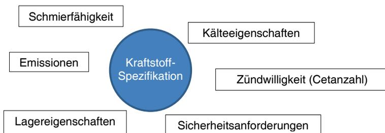
Bild 2: Eigenschaften für eine Kraftstoffspezifikation
