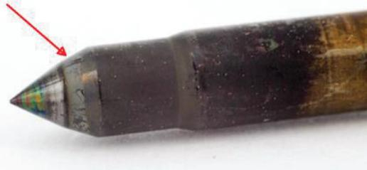
*Abbildung 2: Injektornadel mit IDID bei 200 h Betrieb mit B10 dotiert mit DDSA und einer Natriumquelle, ohne Zink [1]*
