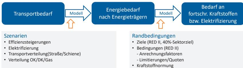
Bild 4: Vorgehen bei der Modellierung des Kraftstoffbedarfs
