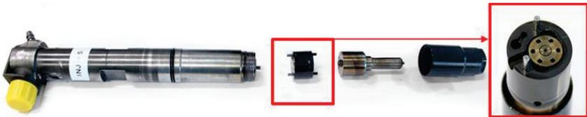
*Abbildung 3: Position des Ventils im Inneren eines Injektors und vergrößerte Vorderansicht des Ventils*
