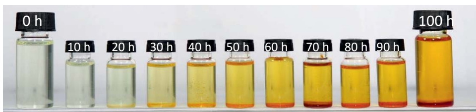
Abbildung 4: Visuelle Darstellung der Alterungsreihe von Diesel R33 mit 250 mg/kg Fließverbesserer, 100 mg/kg Korrosionsinhibitoren und 150 mg/kg Schmierfähigkeitsverbesserer von 0 Stunden bis 100 Stunden
