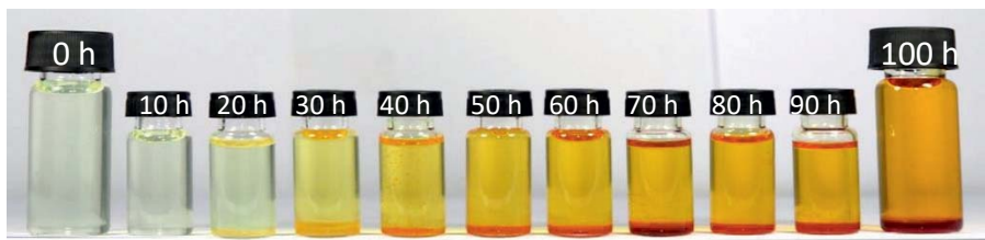
Abbildung 3: Visuelle Darstellung der Alterungsreihe von Diesel R33 mit 100 mg/kg Korrosionsinhibitoren und 150 mg/kg Schmierfähigkeitsverbesserer von 0 Stunden bis 100 Stunden
