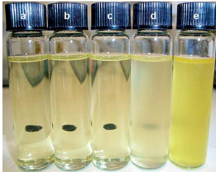
Abbildung 6-17: Untersuchung zur Eignung von ausgewählten 1-Alkoholen als Lösungsvermittler in RMEalt-20-Blends im Vergleich zu TBC und RME (10% Lösungsvermittler-Anteil)
